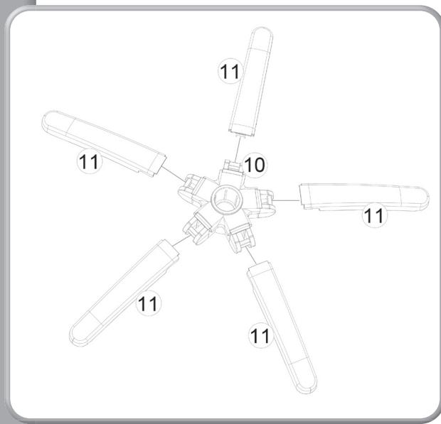
Die Fussteile (11) am Verbindungs teil (10) montieren
