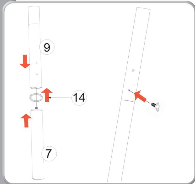
Standrohr (7, 9) und Deckerring (14) zusammenschrauben
