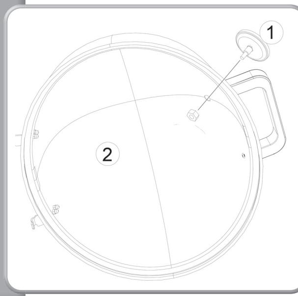
Thermometer (1) am Deckel (2) anschrauben
