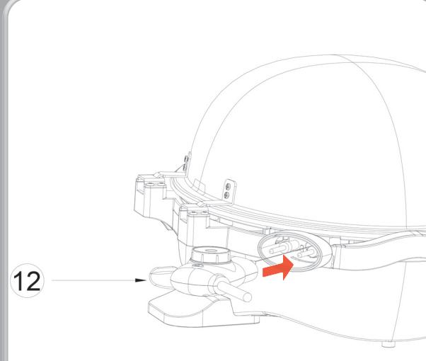
Thermostat (12) von der Rückseite in die Aufnahme der Grillplatte einstecken
